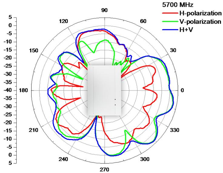
5,7 GHz, Abstrahlungsdiagramm, Antenne Frontseite
